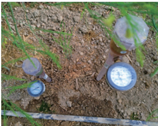
↑設置土壤水分張力計監測灌溉水量 →蘆筍試驗田區生育狀況
