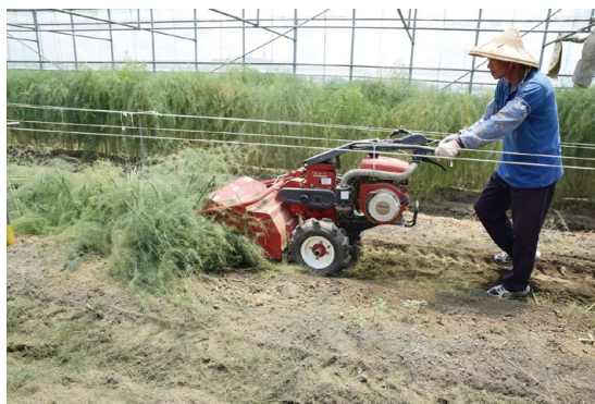
① 修改中段刀具之碎枝機田間碎化割除後老化母莖操作情形
