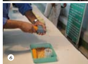
② 馬鈴薯去皮機 ③ 腳踏車式馬鈴薯去皮機 ④ 馬鈴薯削片機 ⑤ 花生脫殼機 ⑥ 手工玉米脫粒器
