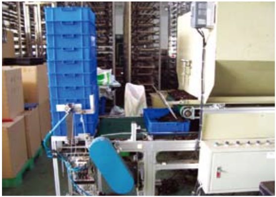
▲ 圖3. 分箱機及介質裝填機組
