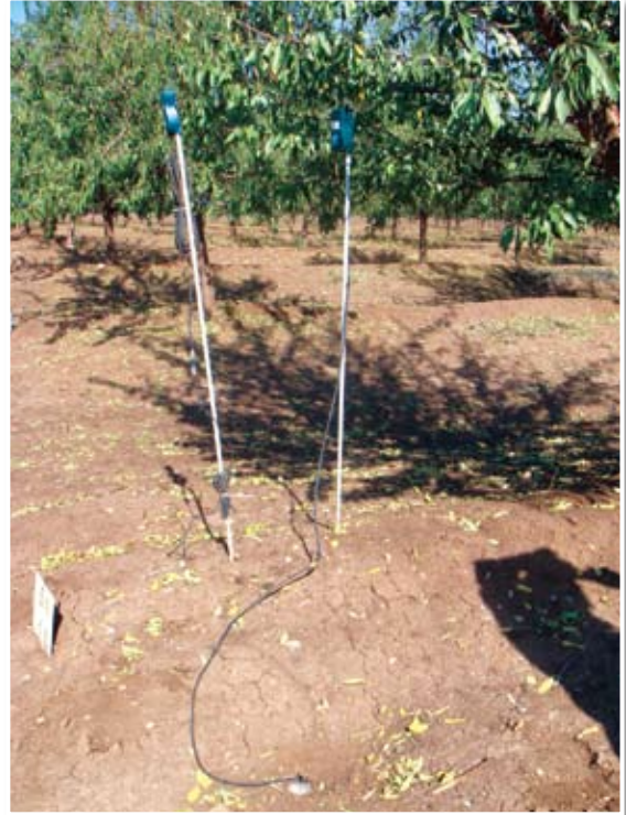
▲ 圖5. 滴灌設備結合感應器及無線發報系統連接電腦，形成自動化滴灌系統
