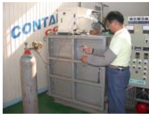
以小型真空預冷機改裝之CO 2 減壓燻蒸試驗設備
