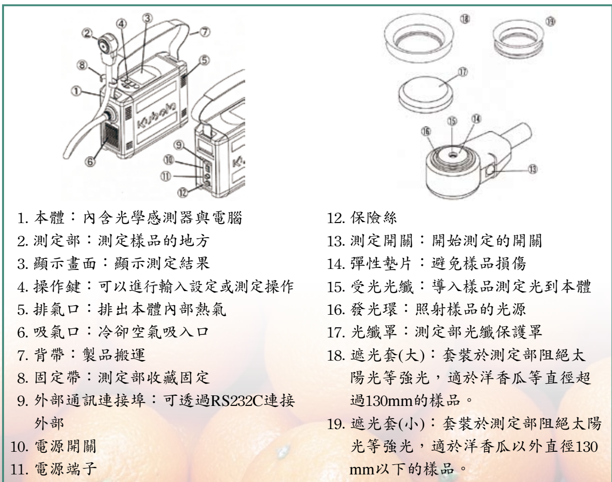
▲ 攜帶型近紅外線非破壞性水果品質檢測器各部名稱和功能
