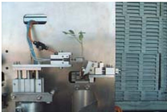
穗木自動夾持切斷定位機構
