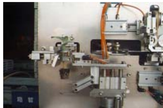
砧木自動夾持切斷定位機構
