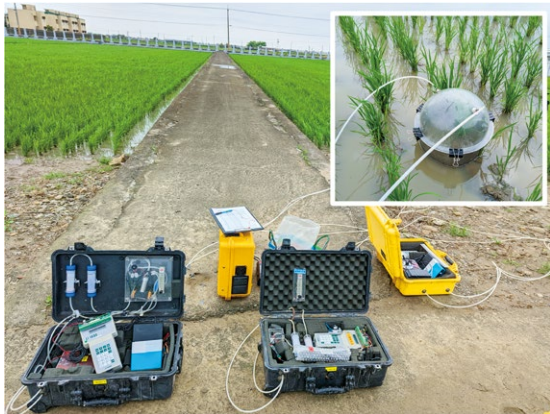
圖二、靜置箱法搭配痕量氣體分析儀即時分析氣體通量
