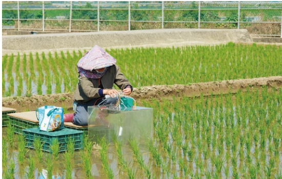
圖一、靜置箱法抽取水田氣體樣品
